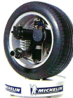
Dans le système Michelin « Active Wheel » tout se trouve dans la roue : le moteur de traction, le frein, la suspension. Les trois sont entièrement électriques. Plus d'usure des freins, plus de fuites d'huile sur les amortisseurs !
