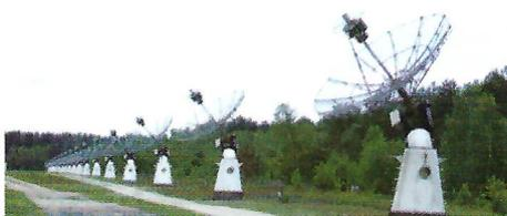
Le radiohéliographe est utilisé comme interféromètre pour des longueurs d'ondes comprises entre 0,7 m et 2 m qui correspondent à des altitudes différentes dans l'atmosphère du soleil : il permet donc d'obtenir des images en 3D.
