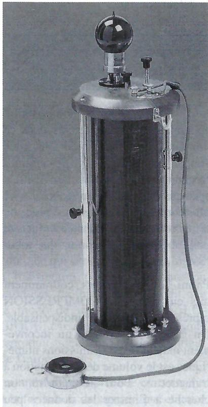
Récepteur Monolampe LEMOUZY type Autodyne (1922). La lampe, placée sur le dessus, est la détectrice. Le réglage de la fréquence se fait grâce à un curseur agissant sur l'auto-inductance du circuit oscillant. (Collection C. BELHACENE)
