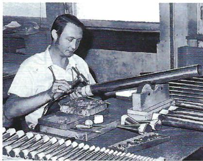
Ouvrier soudeur en train de souder des pieds de tuyaux sur le corps du tuyau avec sa « panne ». En bas, on voit tous les pieds déjà soudés avec leur biseau, et à droite, les corps de tuyaux soudés. La partie blanche qui se trouve au niveau des soudures est un fondant qui permet une meilleure prise de la soudure. Elle sera ensuite éliminée au lavage du tuyau. On utilise aussi de la stéarine comme fondant. Ce travail est délicat et précis mais répétitif. Tâche de spécialiste.
