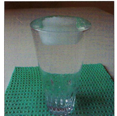
La poussée d'Archimède est égale au poids de l'eau déplacée sous la ligne de flottaison
