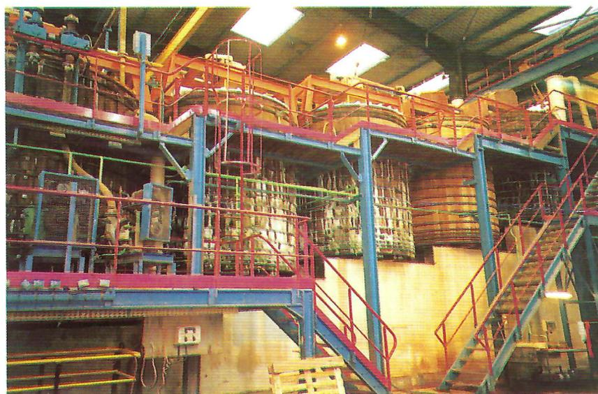
Les cuves, en bois, dans lesquelles la pulpe est attaquée par l'acide sulfurique à chaud pour extraire l'uranium.
