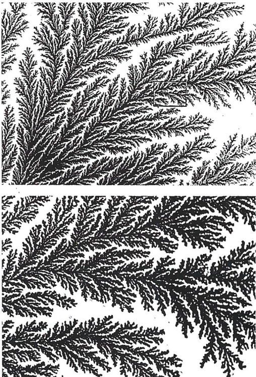
Figure 4 : Ce dépôt électrolytique de cuivre à deux dimensions a été obtenu entre deux plaques de verre très rapprochées. Dans l'image supérieure on délimite un petit rectangle que l'on présente agrandi dans l'image inférieure. Le dépôt reste reconnaissable après avoir subi l'épreuve de la loupe ; on dit qu'il est autosimilaire. ( FLEURY V. Laboratoire PMC, Ecole Polytechnique)
