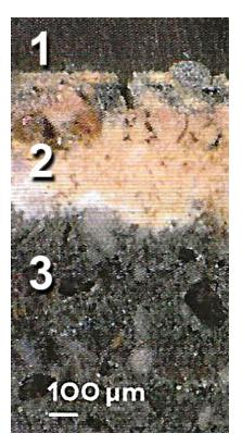
millimètres : tapis irrégulier de polyèdres (grains de quartz) et de microsphères (Pb métal,  $\alpha$ -PbO,  $\beta$ -PbO) de 0,1 à 1 mm de diamètres
