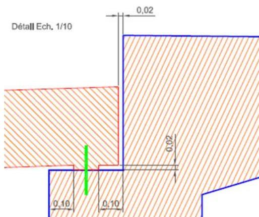
Figure 15 - Détail de la liaison du corbeau avec la dalle de transition d'un PICF [Travail personnel]
