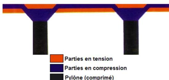
Figure 3 - Répartition des efforts dans un pont à poutres
